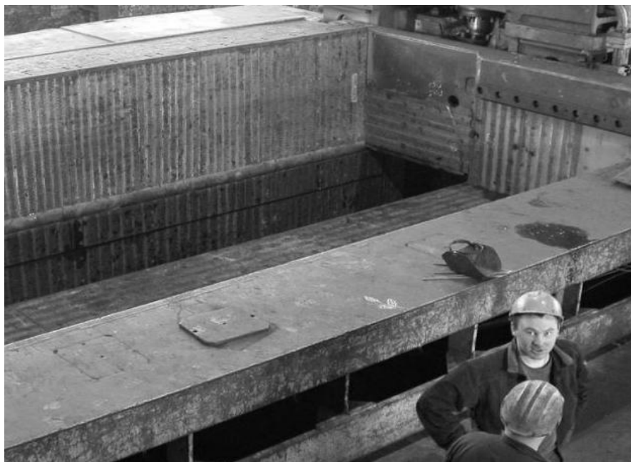
Рис. 3.4.5. Бункер пресс-ножниц, футерованный листами с плазменной закалкой
