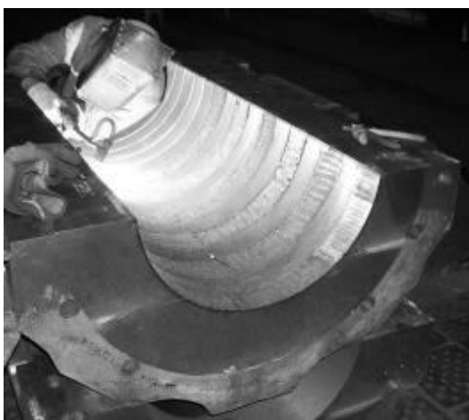
Рис. 3.3.1. Плазменная закалка формовочного штампа
