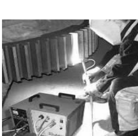
Рис. 1.6. Закалка установкой УДГЗ-200
