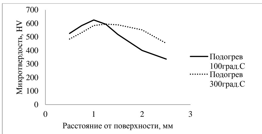
Рис. 2.3.3. Влияние подогрева на микротвердость плазменной закалки головки рельса
