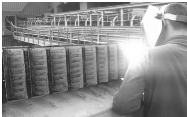
Рис.3.1.3. Плазменная закалка зубчатого венца на шихтовом дворе под открытым небом
