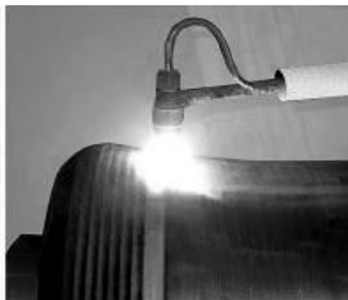
Рис. 3.1.6. Автоматическая закалка правильного вала установкой УДГЗ-200
