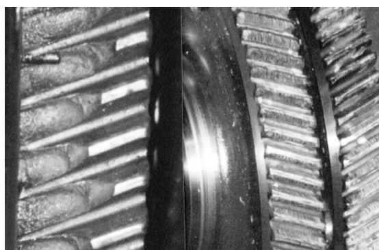
Рис.3.1.2. Плазменная закалка зубьев (справа) исключила поломки имевшие место при закалке ТВЧ (слева)
