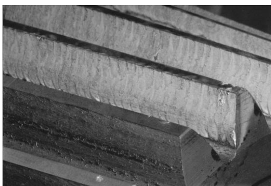
Рис.3.1.1. Плазменная закалка зубьев по боковой поверхности
