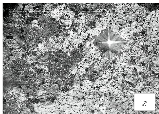
Рис.2.4.2. Микроструктура закаленного слоя в чугуне по мере удаления от поверхности:
