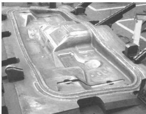
Рис. 3.3.4. Матрица с плазменной закалкой прижимного контура
