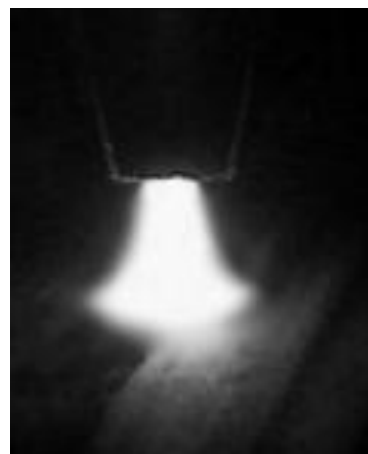
Рис. 1.4. Плазменная дуга во время закалки
