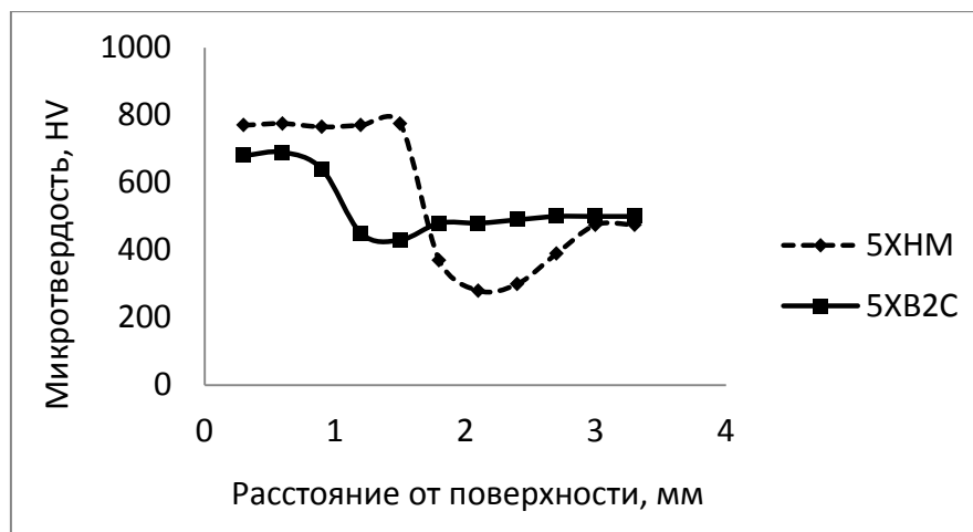
Рис.2.3.6. Распределение микротвердости по глубине плазменной закалки на образцах, прошедших предварительную объемную закалку с отпуском
