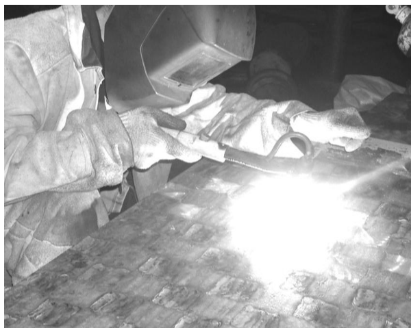
Рис. 3.4.4. Плазменная закалка лицевой планки
