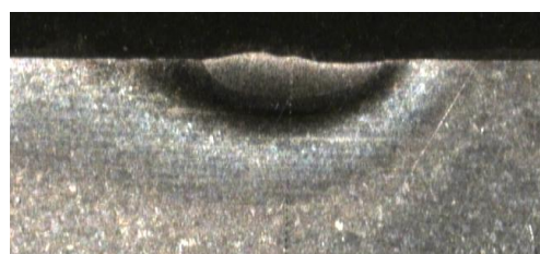
Рис.2.3.7. Оплавление поверхности при плазменной закалке стали 20X13
