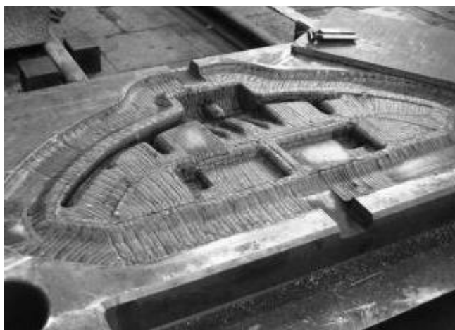
Рис. 3.3.2. Штамп с плазменной закалкой фигуры сложного профиля
