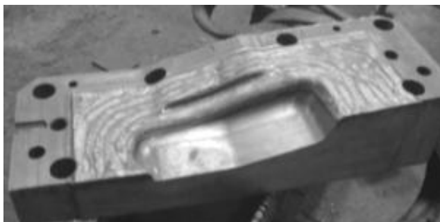
Рис. 3.3.3. Фрагмент разрезного штампа после плазменной закалки
