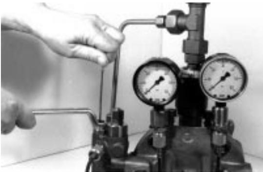
FR: Differenzdruck 14 bar wird eingestellt bei halbem Schwenkwinkel der Pumpe ( einstellbare Drossel in der Systemdruckleitung teilweise geschlossen ).
